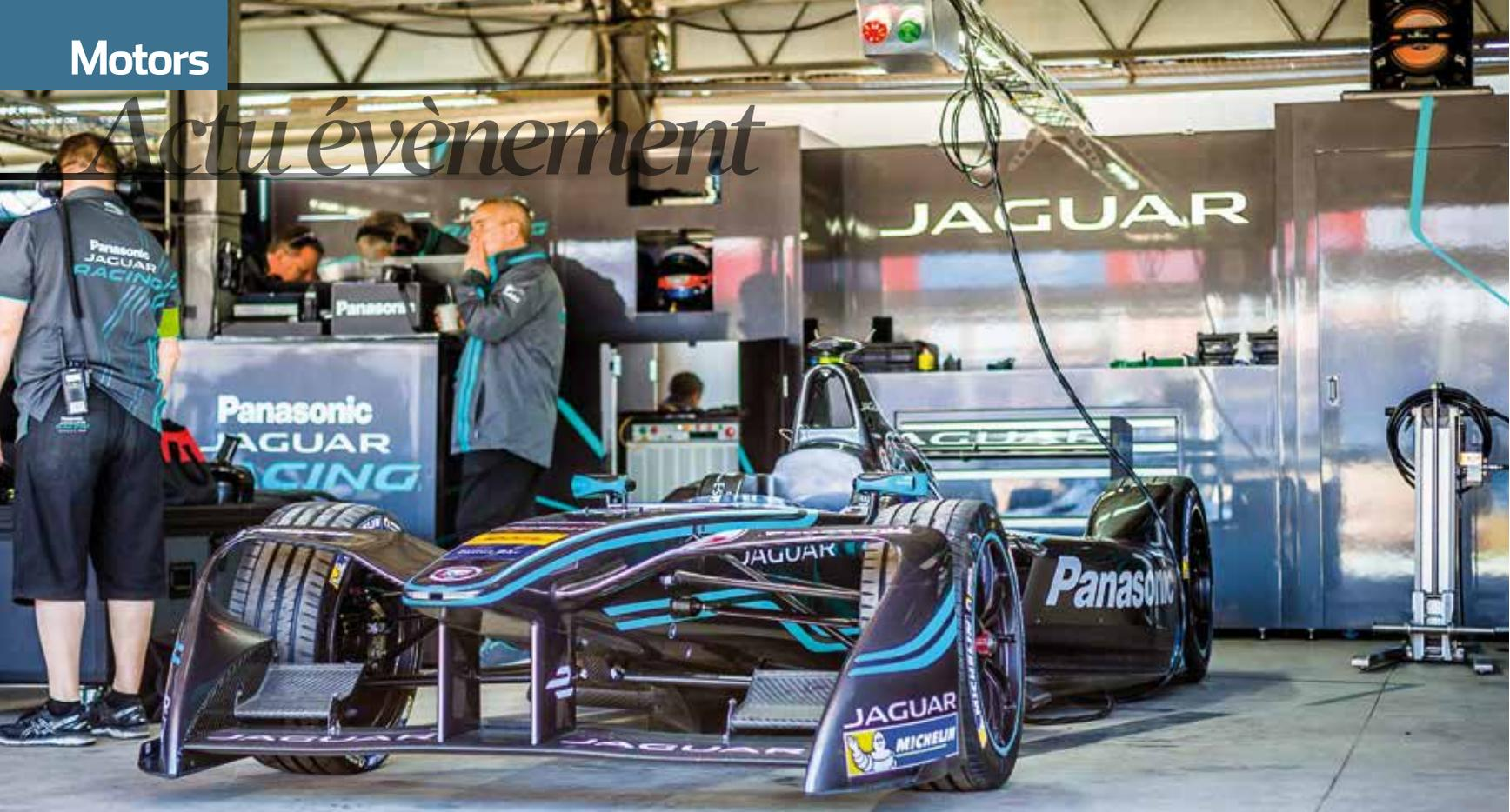
Ainsi, techniquement, la Formule E pèse 880 kilos (la batterie représente à elle seule 320 kg), avec le pilote. La puissance maximale est de 200 KW, soit l'équivalent de 270 chevaux, mais seulement 170 kw, soit 230 ch sont utilisés durant la course, avec une possibilité d'overboost pour doubler. Au niveau des performances, la monoplace est capable d'atteindre la vitesse de
