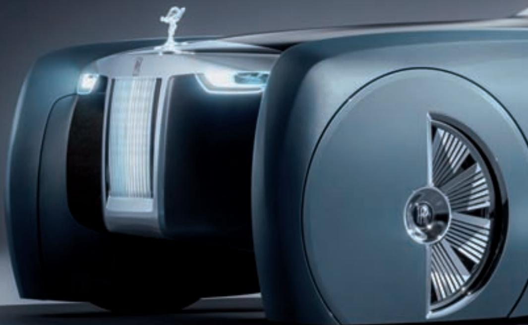
Avec son allure haute sur pattes très minces de 28 pouces partiellement carénées, la Rolls-Royce Vision Next 100 se démarque nettement du dessin rectiligne et massif. Tout est fait pour limiter le frottement avec la route, pour des raisons de consommation et de bruit. Elle sait également fendre l'air avec sa silhouette très profilée façon goutte d'eau, à l'énorme diffuseur s'échappant vers la poupe.
