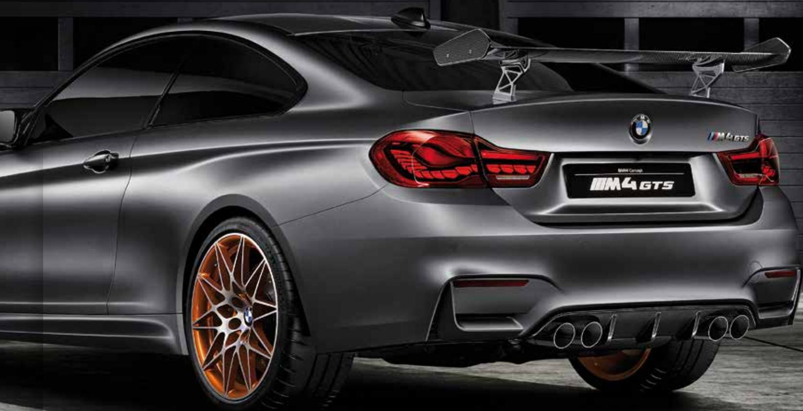
est permis grâce à un allègement conséquent du coupé. Pour atteindre ce résultat, les ingénieurs allemands se sont concentrés sur des matériaux exotiques : l'échappement est en titane, le diffuseur et le capot en plastique renforcé de fibre de carbone (PRFC), les freins mélangent carbone et céramique. La ligne d'échappement est également spécifique, avec un silencieux en titane, permettant une baisse de 20 %, tout
