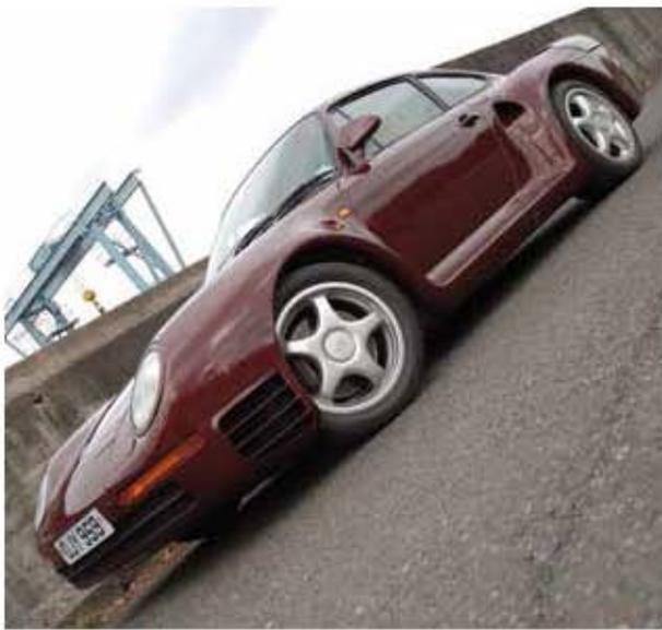
*Esthétiquement, la Porsche 959 est un remodelage de la 911. Une cellule de sécurité centrale est ajoutée. La structure n'est que très peu modifiée et c'est principalement dû au fait que la 959 conserve le moteur en porte-à-faux arrière, alors que ses concurrentes principales disposent d'un moteur central.*
