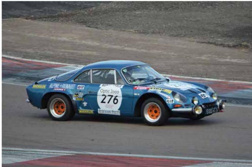
*Dans le droit fil de ce caractère mécanique très affirmé, la maniabilité et la motricité sont les points forts de l'Alpine A110. En effet, la position du moteur en porte à faux arrière entraîne la voiture dans une glissade aisément contrôlable au volant et à l'accélérateur.*
