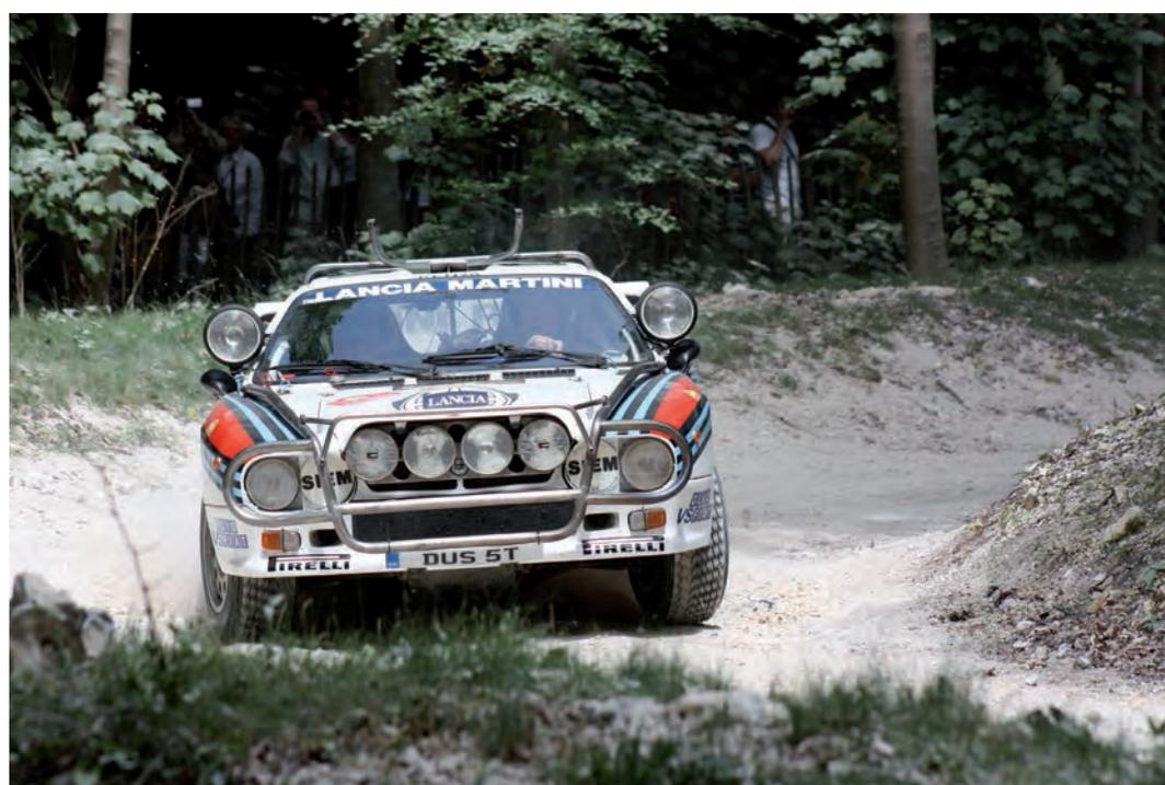
*Grâce à quelques mises au point, la puissance définitive ressort à 320 chevaux pour moins de 800 kg. Quant à la boîte à vitesses, c'est une ZF cinq rapports, avec un pont autobloquant taré à 25%.*
