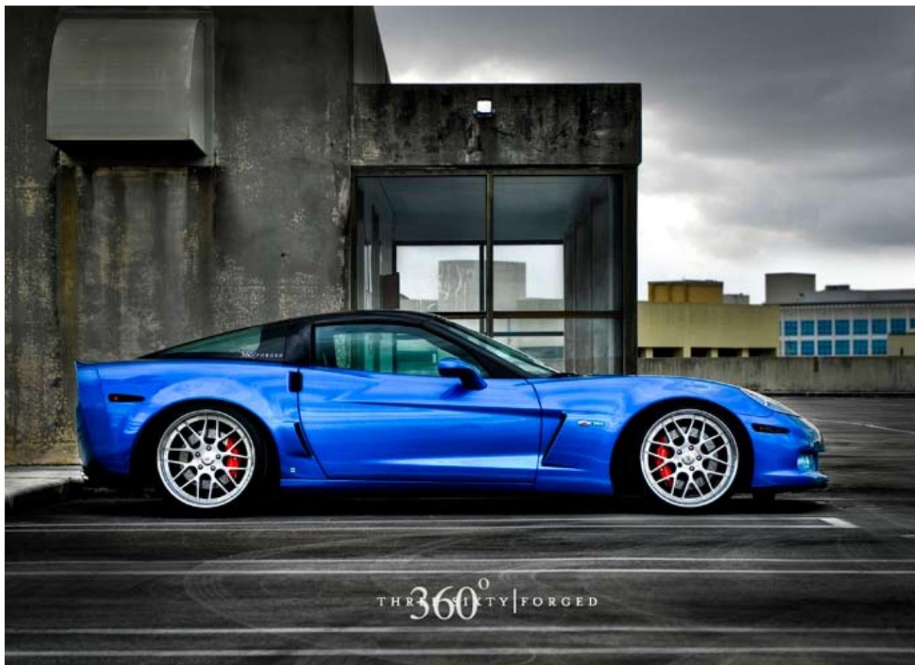
*La Z06 produite en 2008. Des moteurs V8 «LS2» 6.0 L, 400 chevaux et «LS7» 7.0L et 505cv, suspension AV / AR indépendante et une boîte manuelle 6 rapports, ou automatique 5 rapports.*
