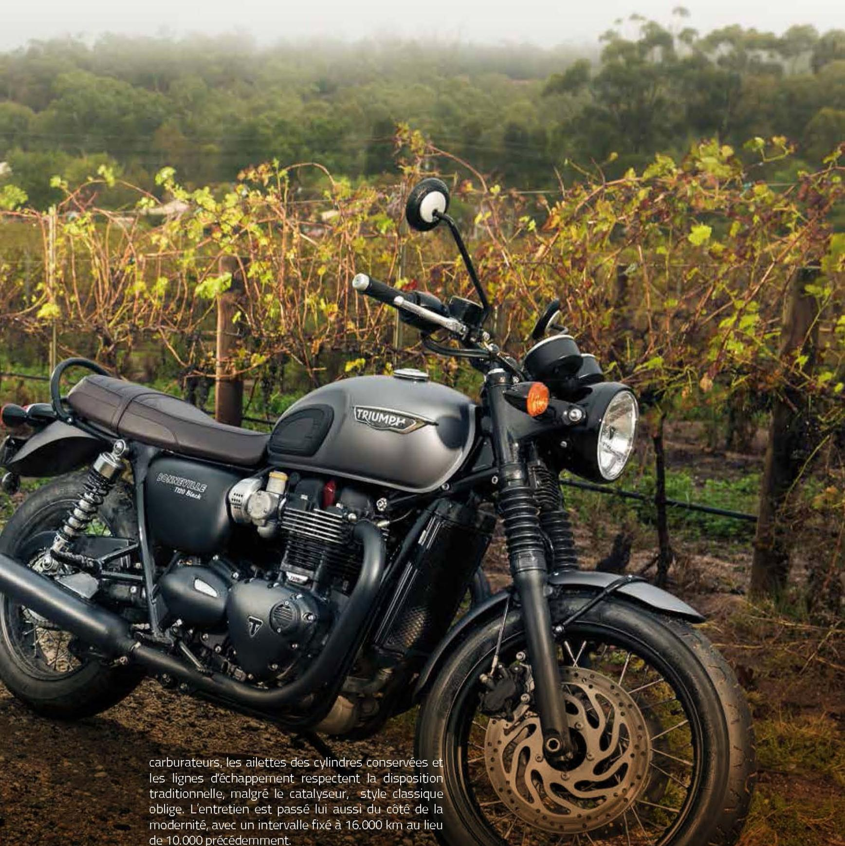
carburateurs, les ailettes des cylindres conservées et les lignes d'échappement respectent la disposition traditionnelle, malgré le catalyseur, style classique oblige. L'entretien est passé lui aussi du côté de la modernité, avec un intervalle fixé à 16.000 km au lieu de 10.000 précédemment.
