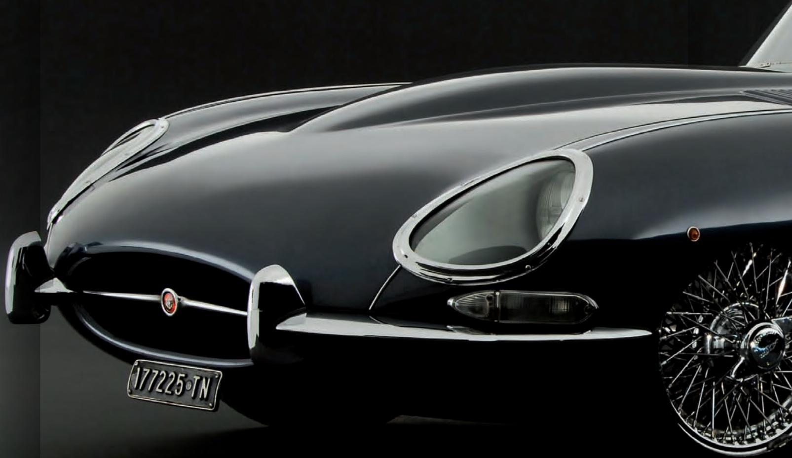
*Les modèles de la série 1 se caractérisent par des phares recouverts de vitres, des demi pare-chocs antérieurs et postérieurs et des commutateurs de tableaux de bord type « aviation ». Les premiers modèles avaient un tableau de bord et une console centrale en aluminium ainsi que des sièges baquets et une boîte de vitesses Moss à première non-synchronisée*
