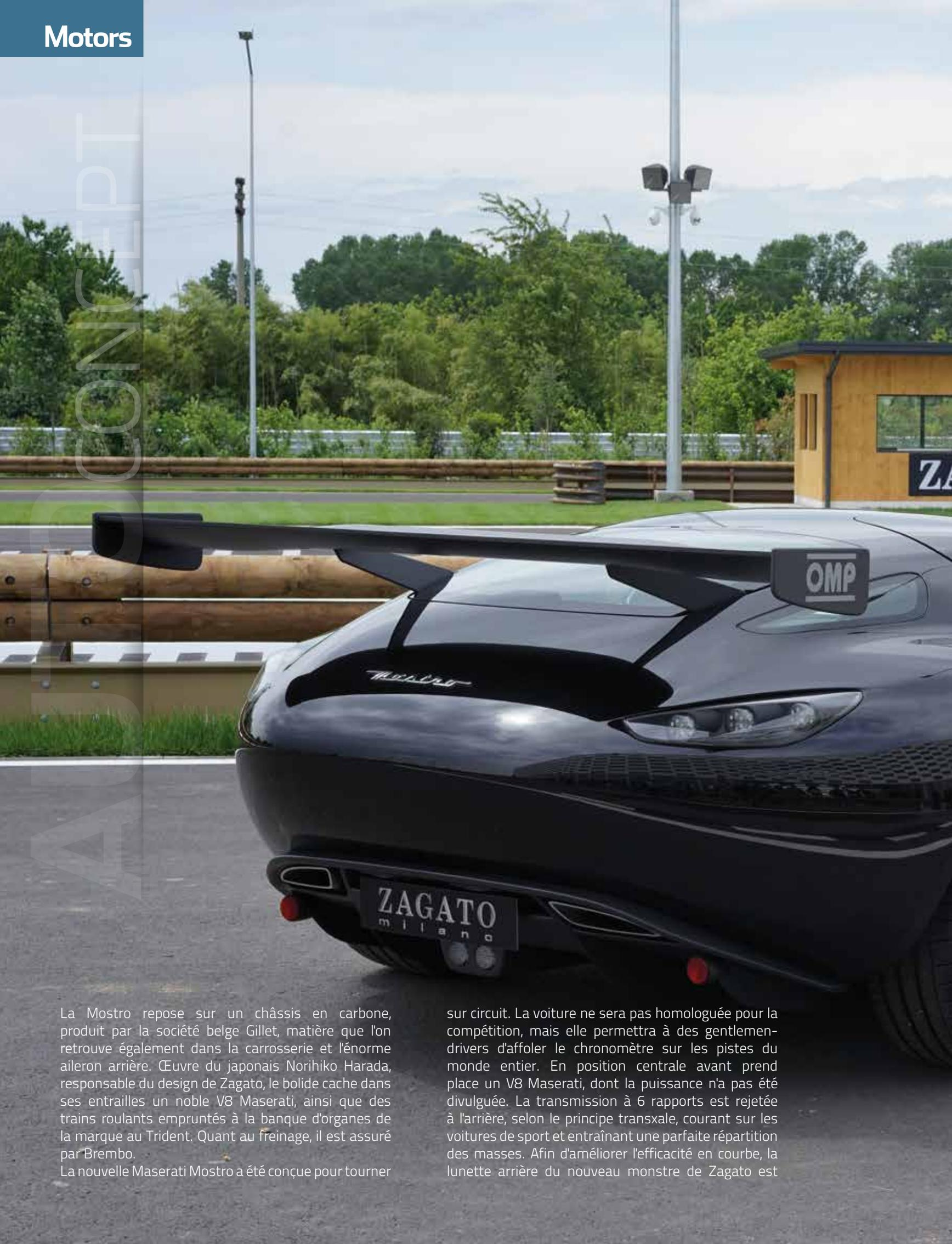
La Mostro repose sur un châssis en carbone, produit par la société belge Gillet, matière que l'on retrouve également dans la carrosserie et l'énorme aileron arrière. Œuvre du japonais Norihiko Harada, responsable du design de Zagato, le bolide cache dans ses entrailles un noble V8 Maserati, ainsi que des trains roulants empruntés à la banque d'organes de la marque au Trident. Quant au freinage, il est assuré par Brembo.
