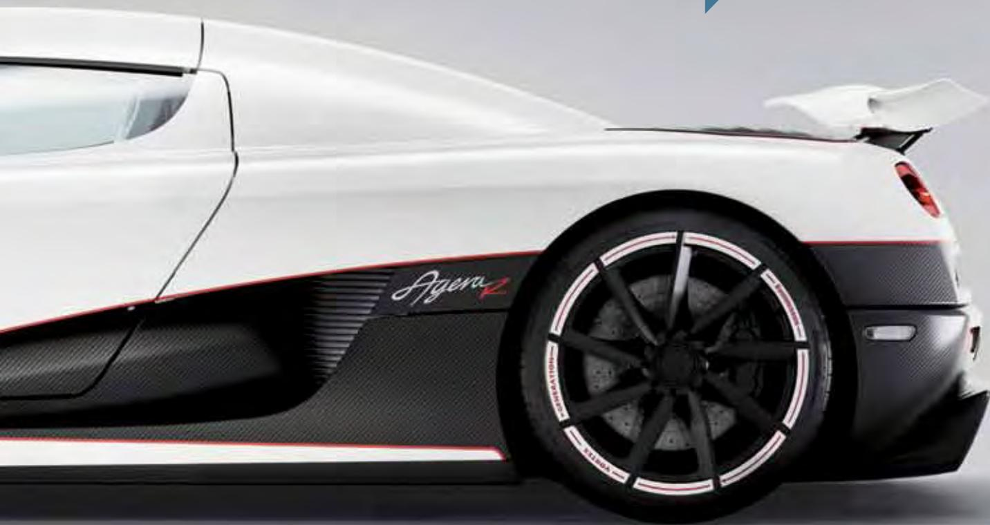
prises d'air latérales, ainsi que des spoilers avant et arrière qui contribuent à la stabilité à haute vitesse, une chose fondamentale pour ce genre de véhicule.
