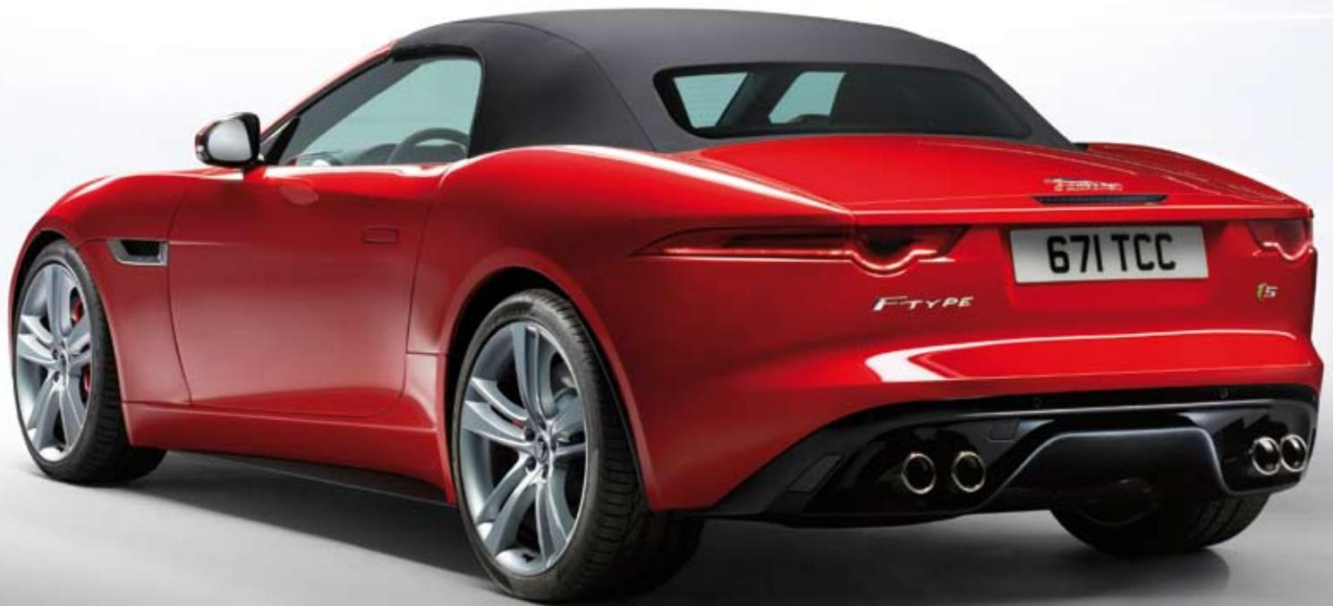
aileron qui se déploie une fois que les 100 km/h sont atteints et qui réduit de ce fait la poussée verticale de 120 kg. Toujours dans cette logique d'aérodynamisme, l'anglaise offre à ses clients des poignées griffées Jaguar qui se rétractent automatiquement pour laisser place à une surface parfaitement lisse. Ils ont vraiment pensé à tout !
