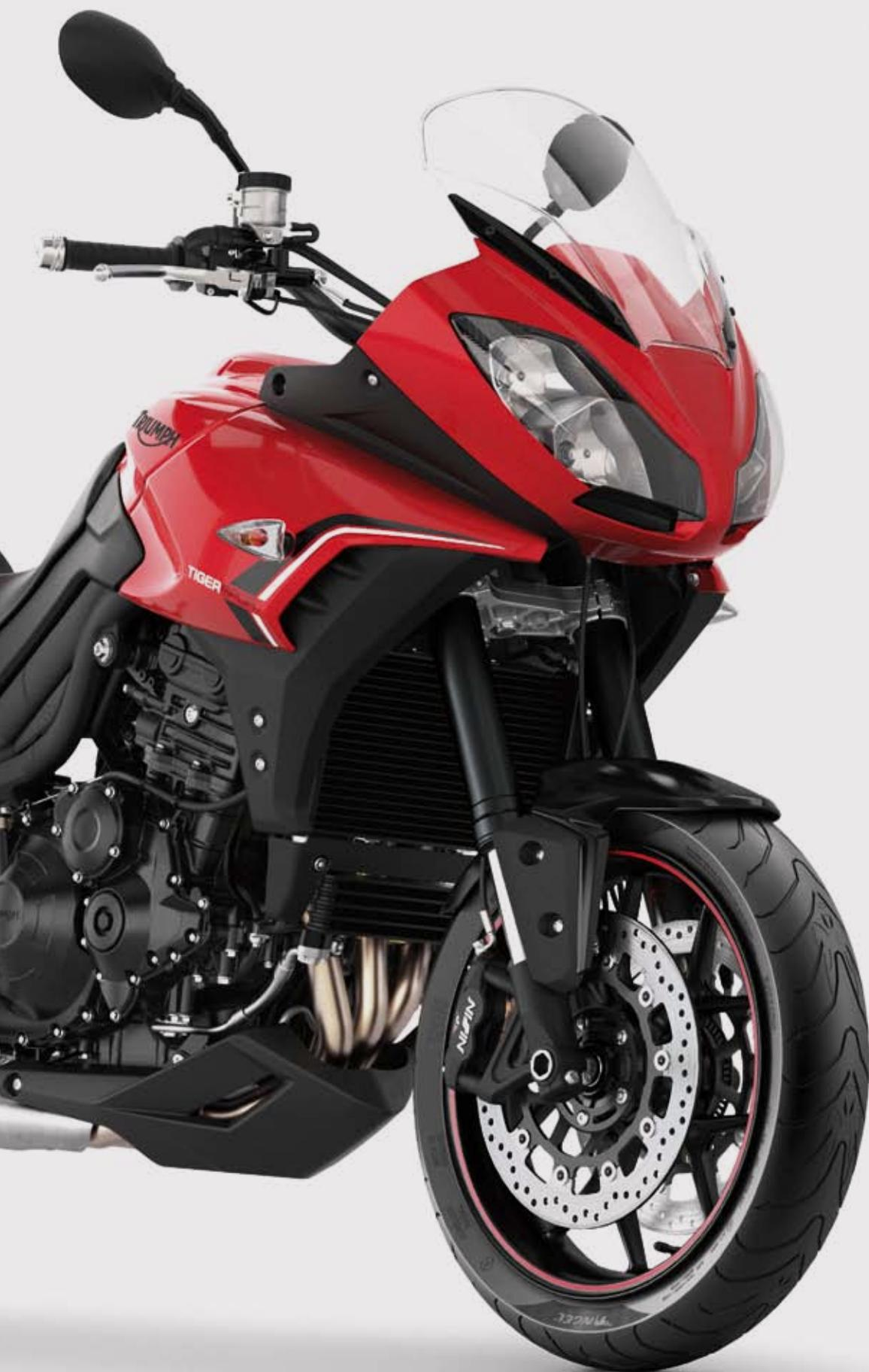
Côté partie cycle, la nouvelle Tiger Sport 2013 conserve les mêmes suspensions avec fourche inversée réglable en précontrainte, détente et compression et amortisseur ajustable en précharge et détente, mais elle adopte un nouvel ensemble de ressorts et de valves, ainsi que des réglages à l'avenant. Les étriers radiaux à quatre pistons Nissin sont
