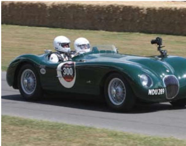
*La type C adoptait un châssis et une carrosserie totalement nouveaux. Le moulin, un 6 cylindres en ligne emprunté à la XK, allait à son tour profiter de quelques aménagements lui garantissant un fonctionnement plus optimal et finira par remporter les 24 H du Mans en 1951, puis en 1953.*
