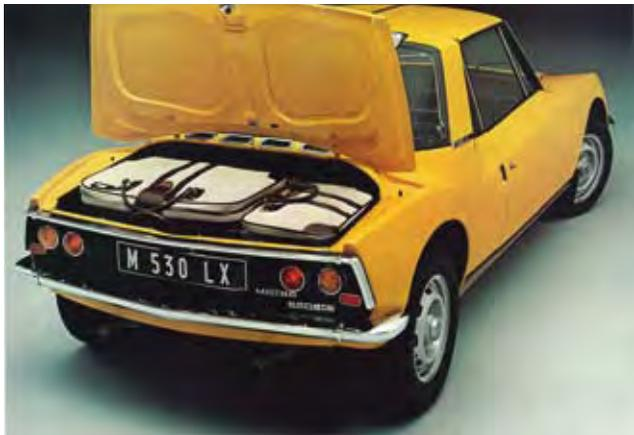
*la 530. Ainsi, le châssis plate-forme ne pèse que 140 kg, tandis que la carrosserie complète est en polyester, et ne pèse que 54 kg ! Fabrication rapide, manutention aisée, absence de corrosion...*
