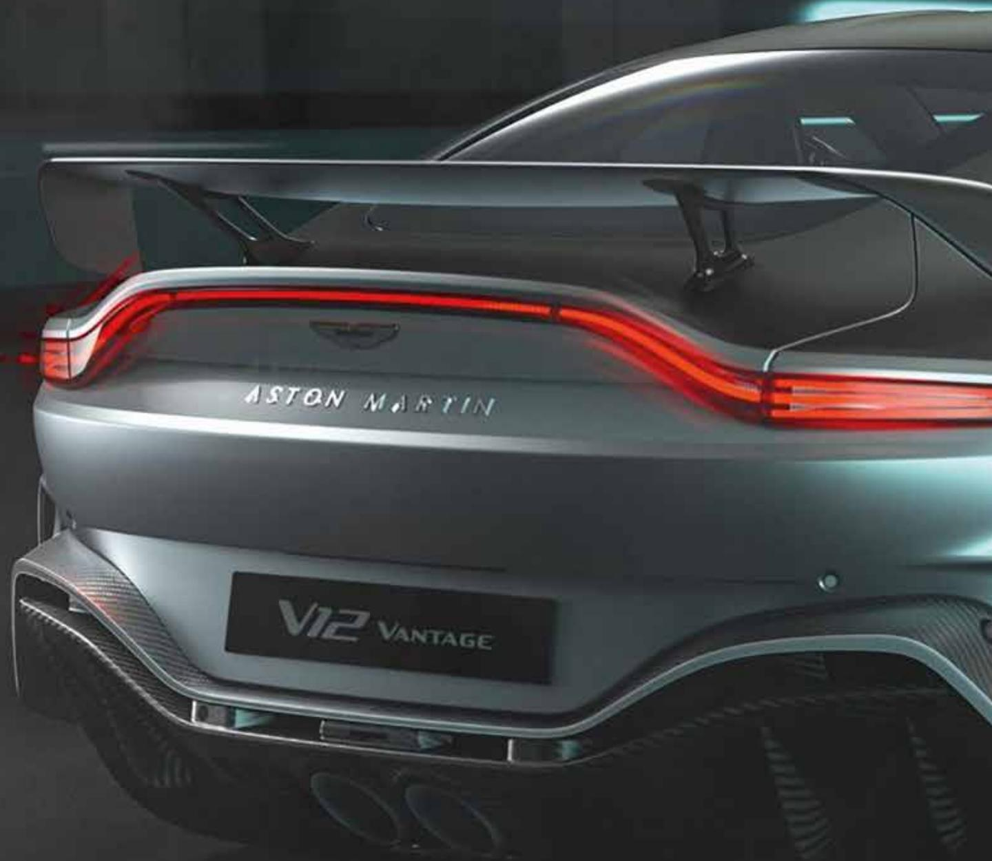
voie élargie. Elle est également dotée d'un capot sur mesure et de nouveaux éléments aérodynamiques, qui permettent d'obtenir une pression équivalente à 450 kg de force à la vitesse maximale du véhicule. La majeure partie de la nouvelle carrosserie est fabriquée en fibre de carbone, afin de gagner en légèreté. Au niveau de la tenue de route, il sied de noter le recours à de nouveaux amortisseurs, barres
