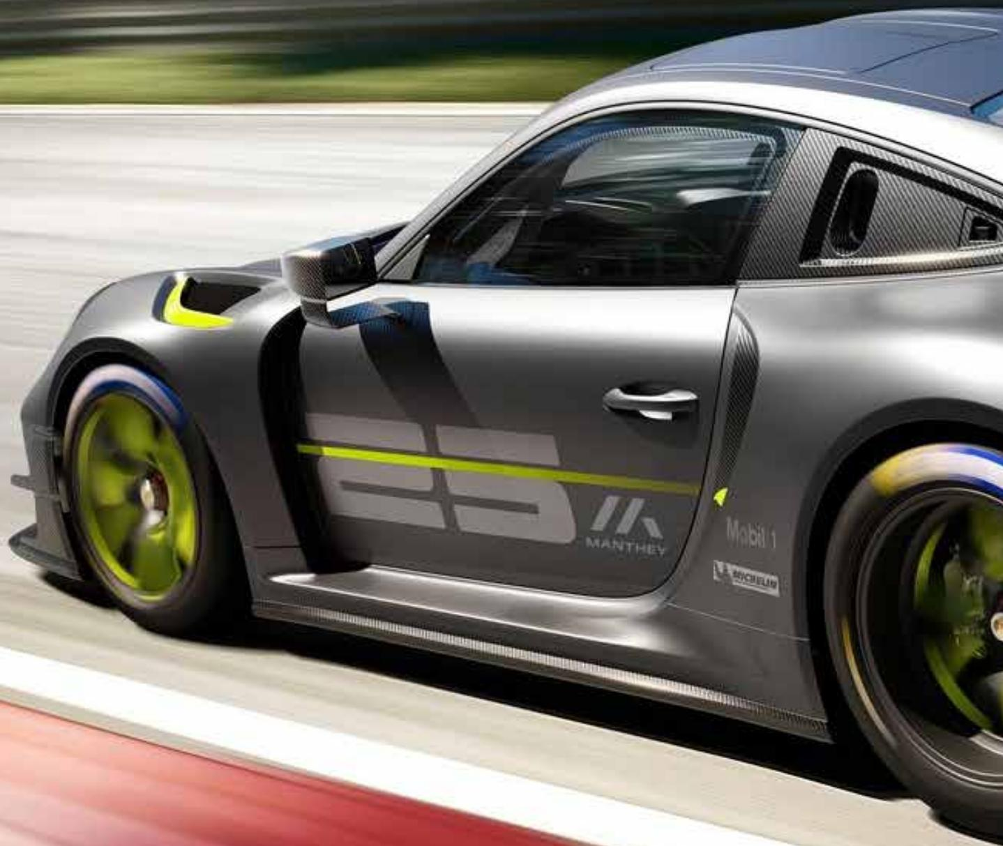
la nouvelle 911 GT3 sont visibles sur le capot avant en fibre de carbone redessiné et, comme sur la 935, des événements allant des ailes avant à l'arrière de la voiture permettent de canaliser l'air chaud vers l'intérieur et l'extérieur de la carrosserie, pour améliorer le refroidissement et l'aérodynamisme. Les phares avant sont des versions adaptées de ceux de la 911 RSR victorieuse au Mans, l'arceau intérieur est une pièce retravaillée de la 911
